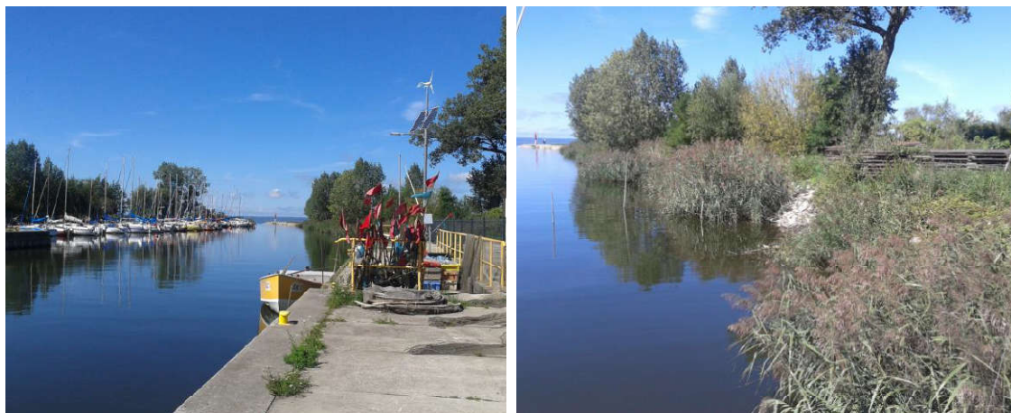
Rysunek 34. Przystań Suchacz. W osi widoczne wejście do przystani z charakterystyczną stawą nabieżnika. Po lewej stronie kanału stanowiska cumownicze dla żeglarzy. Po prawej stronie basenu nabrzeże oczepowe ze stanowiskami dla rybaków (zdjęcie po lewej). Skarpa wschodniej strony basenu jest wzmocniona narzutem kamiennym (zdjęcie po prawej). Stan z sierpnia 2016
